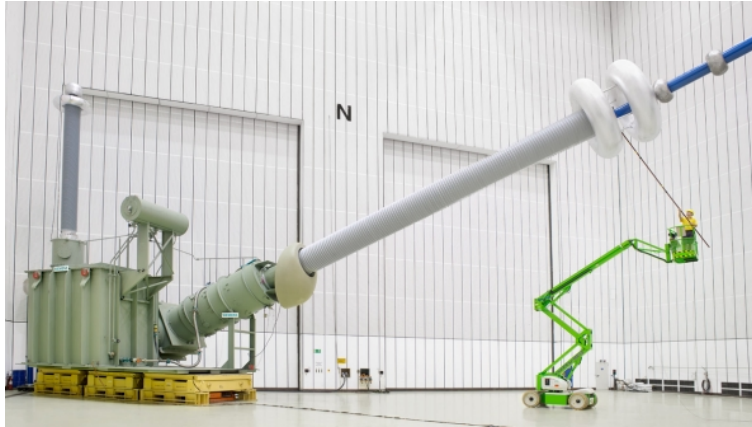
Figur 5: Bild som visar 1100 kV transformator [19]
