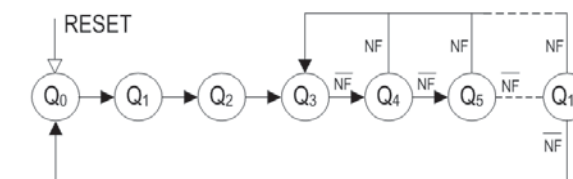
Figur 14.3 Tillståndsgraf för styrenheten
